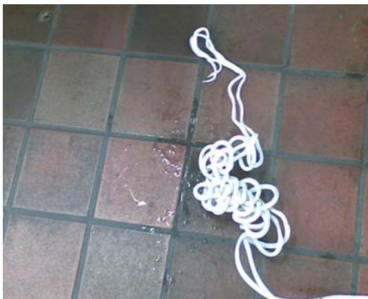
Detta var det vita materialet efter renkörning med Purge Polymer
