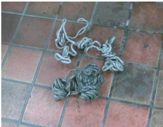
Detta var före och efter renkörning med bara HDPE
